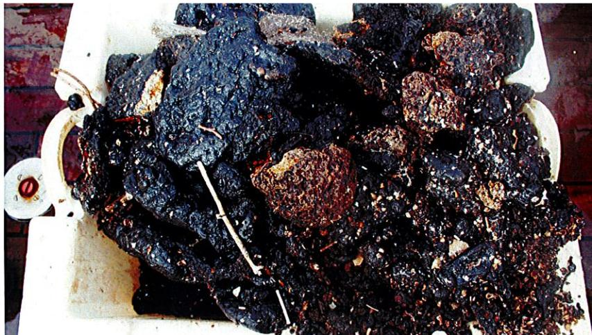
Contenu d'une drague montrant les roches à encroûtement polymétalliques, remontée au sud ouest de Kaukura lors de la campagne TARASOC
