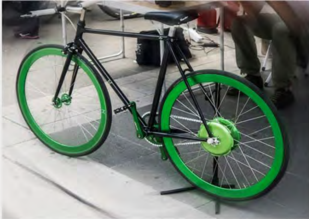
Zehus Wize hub : NC | 30km assistance 100%, infinie avec Bike+ | 3h | 3kg | 20 à 29"
